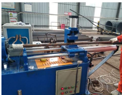
4.8-1 数控小导管冲孔机
