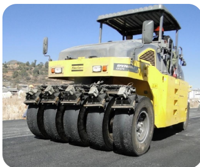
图 2.6-3 带自动喷淋防粘剂的轮胎压路机
