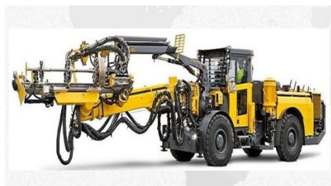
4.6-3 钻孔、注浆及安装锚杆一体机
