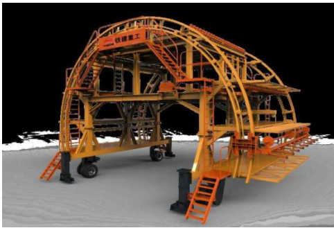
4.7-5 半自动防水板铺挂台车（一）
