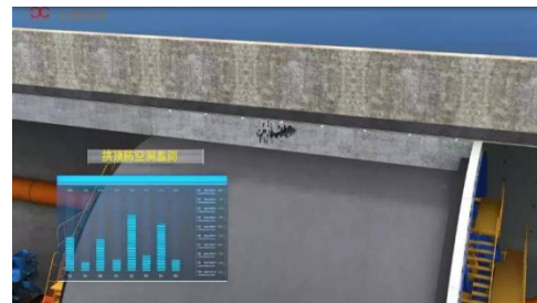
4.11-10 二衬拱顶防空洞监测
