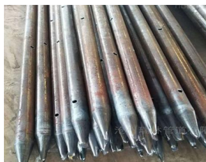
4.8-2 小导管冲孔缩尖效果
