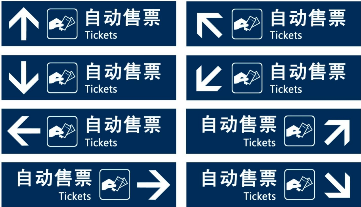
图 E.1.1 标志布置图形符号、文字布置方式
