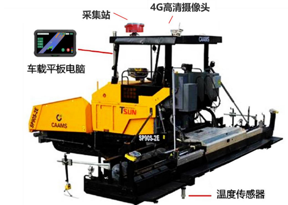
图 5.1 摊铺智能管控设备组成
